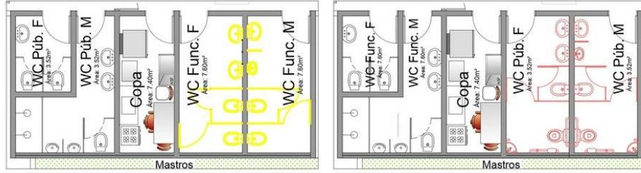
DETALHE 04 - PLANTA BAIXA DEMOLIR
